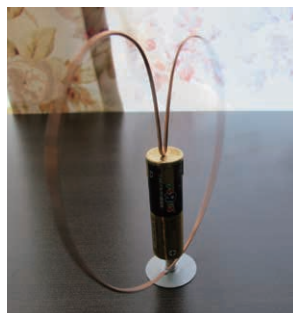
▲図1 ①単三乾電池②ネオジム磁石③銅線④金属台
