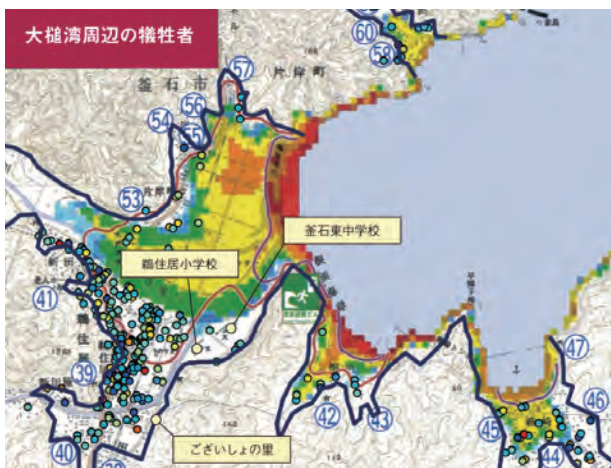
釜石市作成の津波浸水予測図の上に2011年の大津波の被害が記されている。濃紺の線が津波の浸水域。過去の津波浸水域（紫・オレンジの線）を超えた所で犠牲者が多い。群馬大田敏孝教授の研究から。（JST「サイエンスウィンドウ」2011年夏号より転載）
